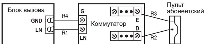
**Во избежание наводок и шумов** провода разговорной линии (клеммы “GND”, “LN” блока вызова) и провода питания должны быть расположены в разных кабелях.
