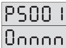
Система войдет в режим редактирования параметров подъезда. Появится попеременная индикация
