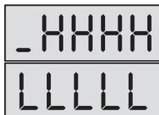
3. Для перехода к перезаписи версии программы необходимо нажать кнопку «В». Текущая индикация пропадает. Загрузка новой версии программы длится около 30 сек. В случае успешного окончания изменения версии программы на индикаторе отображается
